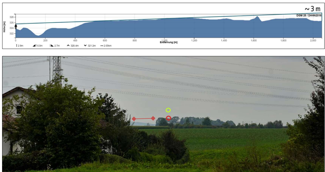
Abbildung 69. Sichtlinie D3 - Kath. Wallfahrts- und Filialkirche zum Hl. Kreuz zum Plangebiet. In orange ist der einsehbare Abschnitt auf ca. 20 m Höhe gemäß BPlan dargestellt
