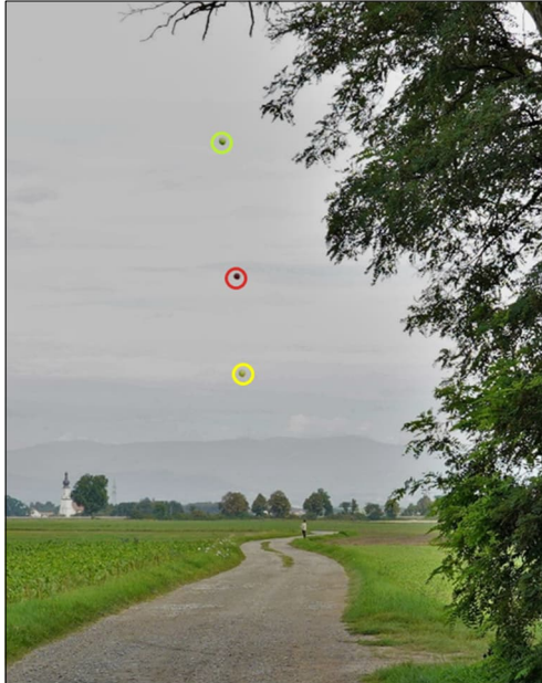
Abbildung 62. Sichtachse C2 – Validierung der Sichtachsen mit Hilfe von Messballons bei der Kapelle auf dem Irlbacher Feld.
